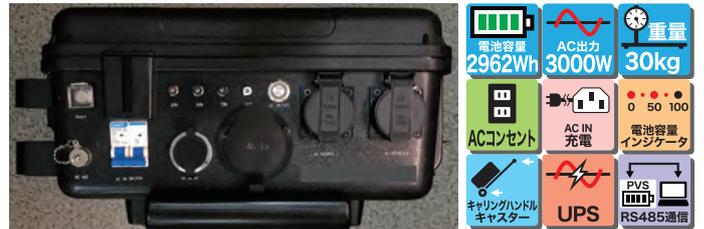
ポータブルバッテリーの電池容量を離れた場所から遠隔監視し、コントロールしたいというニーズを実現。産業用、工業用、他のシステムとの連携に必要な基本的なシリアル通信機能として普及しているRS485通信機能を採用しました。RS485は、通信距離が長い、通信スピードが速いなどの特長を持ち、工場や機械の制御などに幅広く普及しています。筐体の上部にRS485の通信用コネクタを出しています。標準付属品のRS485通信ケーブル PVSAC-TRS485Sを接続してパソコンのCOMポート(USB-Aコネクタ)にPVS-3000UTのデータを取り入れ、Windowsの通信モニターソフトウェアでポータブルバッテリーの状態を確認します。
