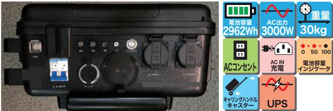
3000W AC定格出力のポータブルバッテリーでUPS機能付コピー複合機や医療用システムの複数台数導入でもバックアップ電源が可能になりました。官公庁、公共事業体、地方自治体などの防災システムは、1KW以上の消費電力を持つ機器が、さらに病院では1台当たり1KW程度の酸素吸入器、透析器、心電図、各種モニタリングシステムなどが大量導入されています。PVS-3000UのUPS機能は、ゼロクロススイッチ理論に基づく最新技術で、停電などの交流電力遮断をわずか5msで検出し、DCACインバータ出力に切り替える機能(8ms~12ms)を持っています。災害時に防災無線ネットワーク機器のバックアップに採用すれば、情報網を遮断することなく運用できます。また、電力の停止(いわゆるブラックアウト)が、即生命の危機につながる医療機器の常時運転が必須の患者にもバックアップシステムとなります。
